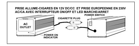
QUAND VOUS BRANCHEZ VOTRE CONVERTISSEUR DE TENSION A UN APPAREIL, METTEZ D'ABORD SOUS TENSION LE CONVERTISSEUR ET PUIS SEULEMENT L'APPAREIL ELECTRIQUE OU ELECTRONIQUE REQUERANT DU COURANT ALTERNATIF.
